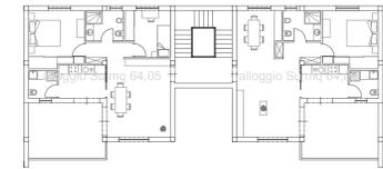
Palazzina tipo 1 - Pianta piano primo e secondo
